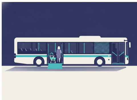
Le bus à plain-pied : le trottoir et le plancher au même niveau.
