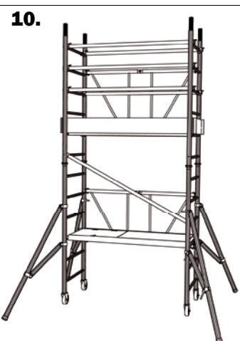
stillaset. Dra til slutt i begge innfestingene stramt. Støttebenene skal stå stødig på underlaget og stillaset skal stå vertikalt. (fig. 1 - 2 side 13)
