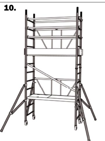
ut minst 1 m från ställningen. Dra slutligen åt båda infästningarna stadtigt. Stödbenen skall stå stadigt på underlaget och ställningen skall stå vertikalt. (fig. 1 - 2 sid 7).
