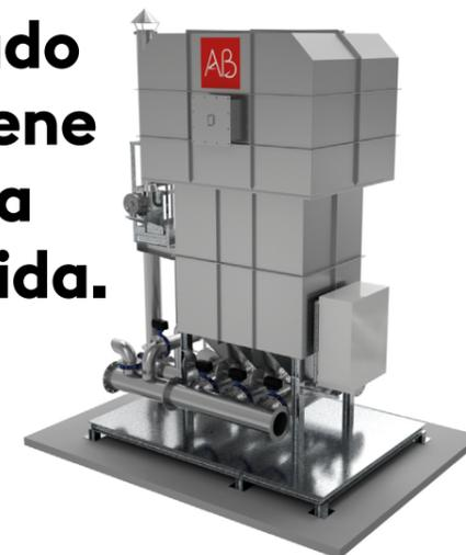
La oxidación térmica regenerativa es una modalidad flexible y energéticamente eficiente, que combina la oxidación térmica de los COV en fase gaseosa, con el fin de eliminar los contaminantes residuales del proceso de mejora del biogás, con el intercambio de calor regenerativo que hace que el OPEX de estas plantas sea menos impactante dado su
