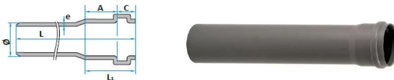
**Dimensiones para los tubos de PVC-U 3KKK evacuación Serie B con boca de junta (TD)**
