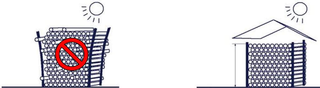
Los soportes laterales de los haces deben ser colocados en intervalos máximos de 1,5 m. Los tubos PVC-U 3KKK evacuación Serie B deben ser soportados en toda su longitud. Tubos de diferentes diámetros y espesores deben ser almacenados separadamente. En caso de que esto no sea posible, los de mayor diámetro y espesor deben ser colocados en el fondo.
