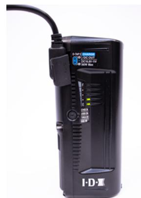
**Figure 3.2.b : Voyants lumineux de charge de la batterie**
