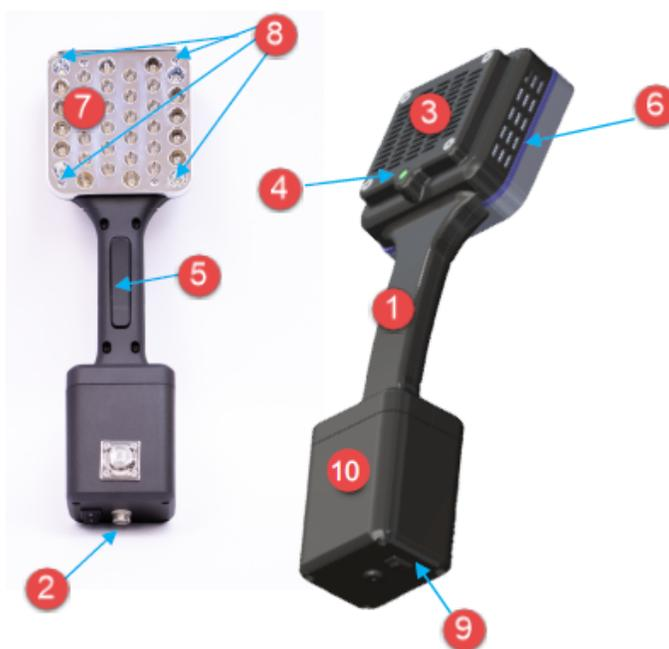
**Figure 3.1.a: Dispositif de désinfection portatif NuvaWave**
