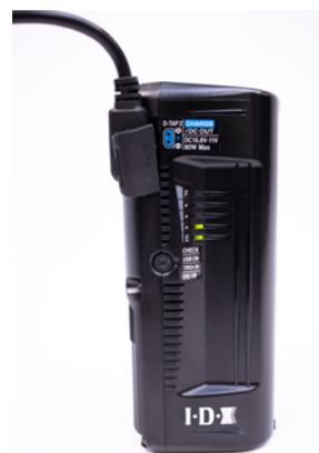
Figura 3.2.b: Luces indicadoras de carga de la batería
