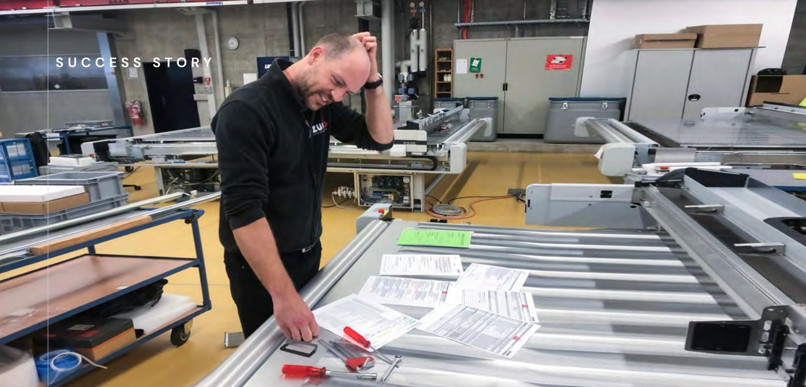
innerhalb einer vorgegebenen Toleranz montiert werden. Während der Montage **3** des Vakuumschisches, der Balken und der Steuereinheit gibt es viele Messpunkte in Bezug auf die elektrische Sicherheit, die elektrische Verkabelung, die Positioniergenauigkeit des Prozesses, das Schwingen der gesamten Anlage etc. Sind diese Einstellungen korrekt, wird die Anlage für den Versand **4** vorbereitet. Dabei werden verschiedene Komponenten für den Kunden bereitgestellt und die
