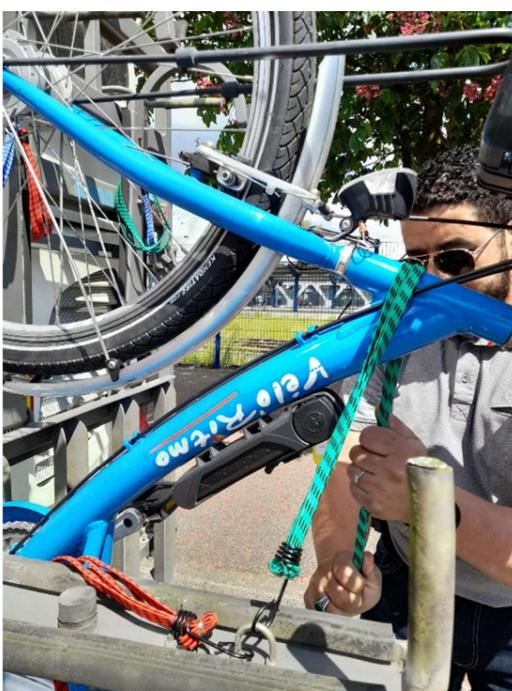
Sangler le cadre du vélo avec un détendeur en utilisant les crochets sur le bras articulé
