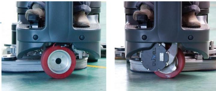
Nuovo sistema di testata lavante traslabile collegata meccanicamente con lo sterzo: quando l'operatore sterza a sinistra, la testata si sposta a sinistra (lo stesso avviene sul lato destro). Il tergilavaggio segue la testata garantendo una perfetta asciugatura anche in caso di curve strette. Si sgancia in caso di contatto con eventuali ostacoli.
