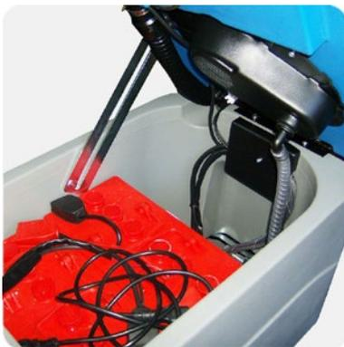
Serbatoio rialzabile per un comodo accesso al vano batterie.
