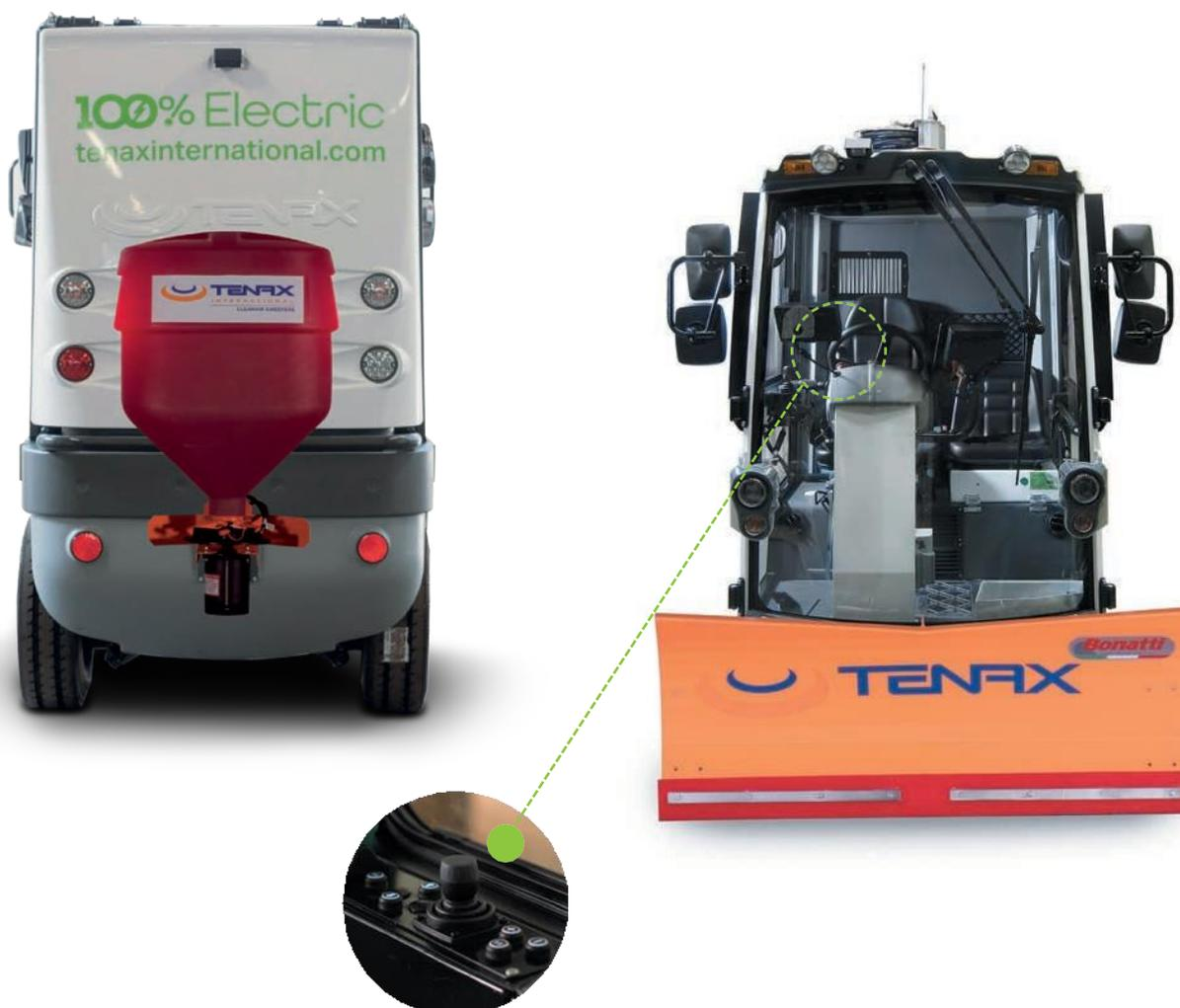
La spazzatrice elettrica Electra 2.0 Evos+ e la lavastrate elettrica Electra 2.0 Hydros possono essere equipaggiate con una lama sgombraneve da 1.600 mm o con una spazzola sgombraneve di lunghezza 1.400 mm e diametro 330 mm installate frontalmente al posto della barra di lavaggio per consentire una pulizia e sgombrò delle strade in presenza di neve. La lama spartineve è gestita da apposito comando in cabina per regolazione.
