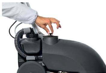
La valvola di sfiato sul tappo del serbatoio soluzione garantisce sempre la stessa quantità d'acqua sul pavimento per un pulito costante.
