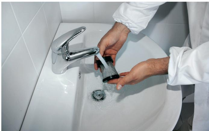
La pulizia periodica del tubo di aspirazione garantisce un'efficiente asciugatura nel tempo.
