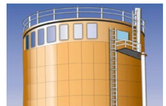
Druckentlastung über Berstscheiben
