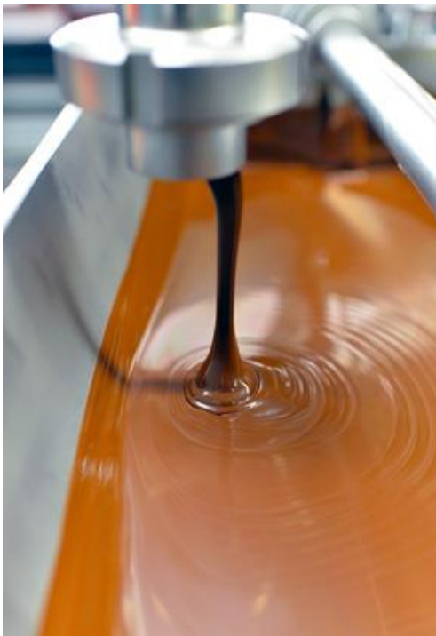
Bild 2: Schokoladenproduktion – hier muss eine niedrige Luftfeuchte herrschen
