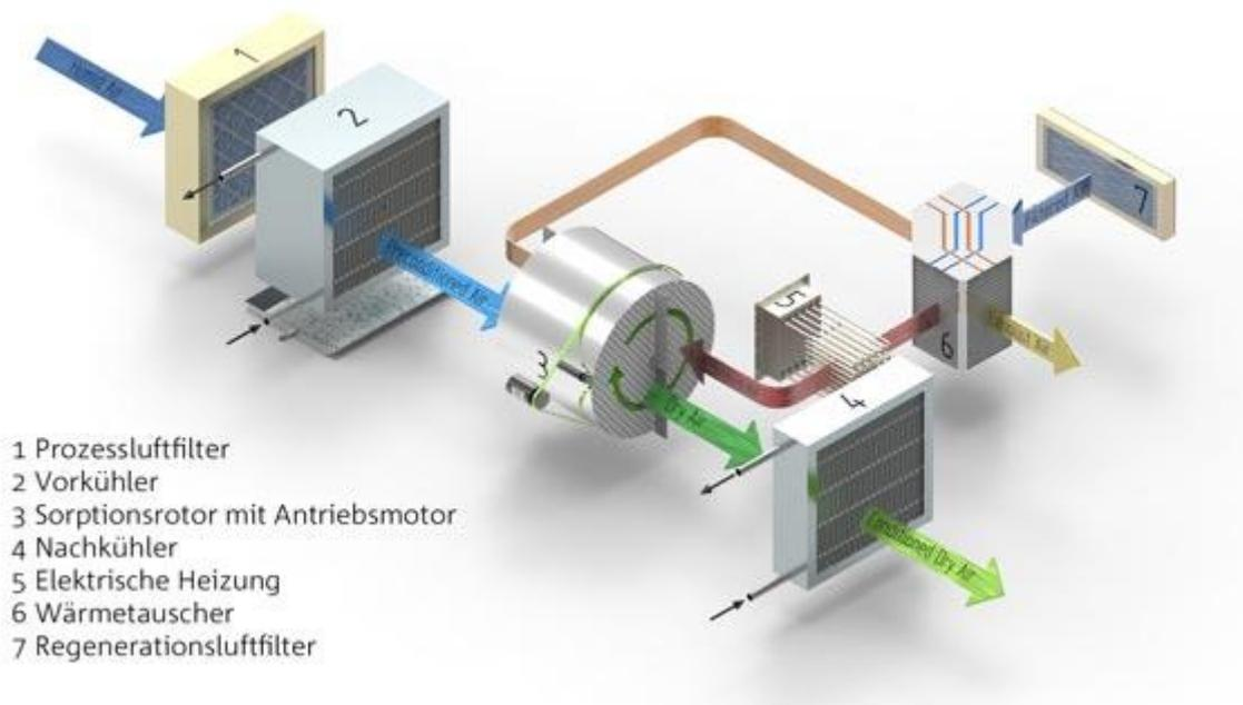
*Bild 3: Beispiel eines Prozessluft-Trocknungsprozesses basierend auf Sorptionsverfahren*
