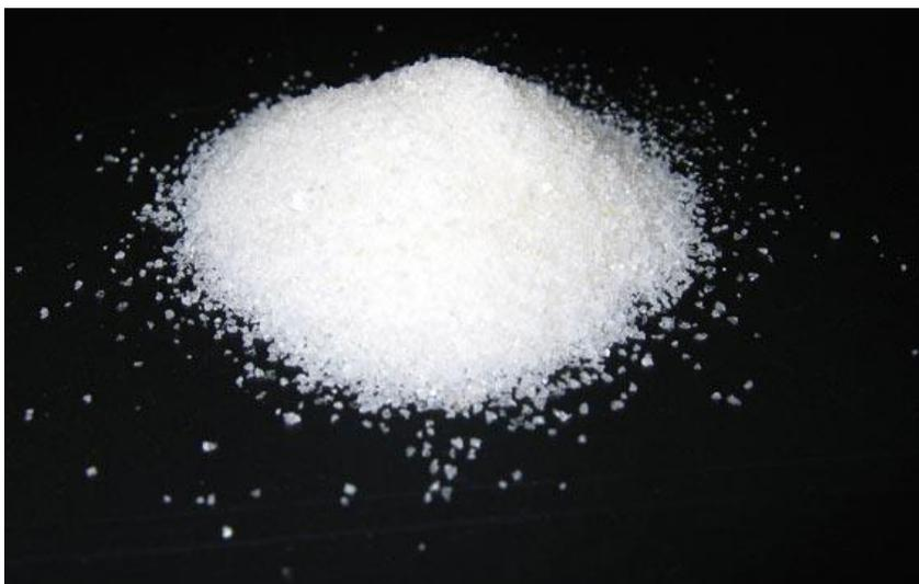
*Bild 2: Superabsorber-Pulver (Quelle: wikipedia)*
