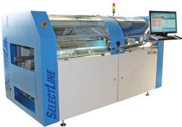
Lötanlage zum Selektivlöten (© SEHO Systems)
