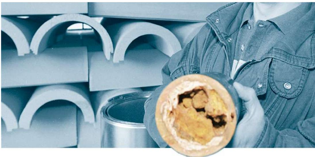
Dieses zugesetzte Graugussrohr stammt aus einer etwa 100 Jahre alten Wasserleitung
