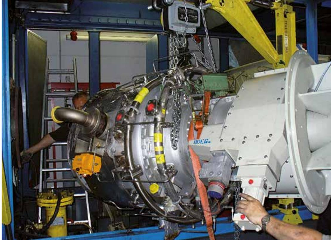
Die neue Gasturbine hat ein so genanntes SoLoNOx-Brennkammersystem. Dieses ermöglicht auf einfache Weise die Erfüllung der strengen NOx-Emissionsgrenzwerte ohne Wassereinspritzung. Die Verbrennung unter Magermischbedingungen reduziert die Umwandlung von atmosphärischem Stickstoff zu NOx (Stickoxide) innerhalb der Gasturbinenbrennkammer, indem die Flammentemperatur reduziert wird.
