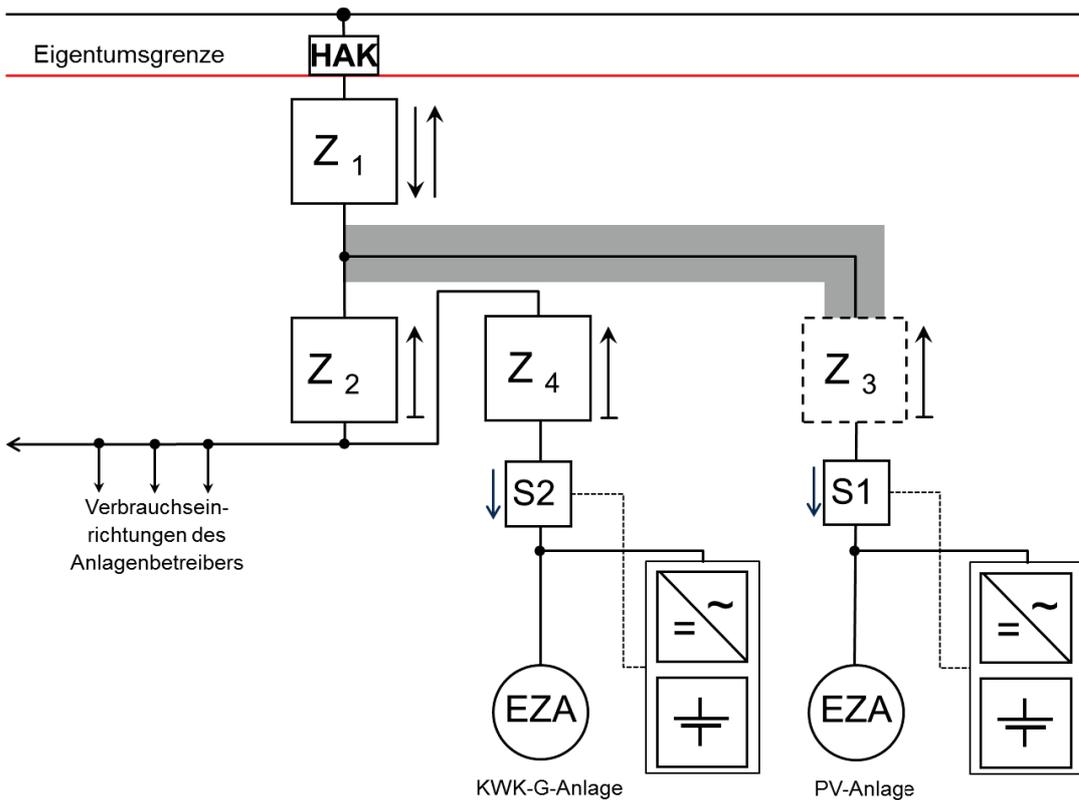
Abbildung 7: Speicher im Erzeugungspfad mit KWK-Anlage und PV-Anlage
