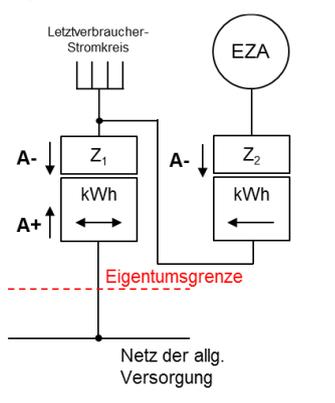
Einspeisung in die Kundenanlage mit Erzeugungszähler, Vollstromeinspeisung mittels kaufm.-bilanzieller Weitergabe, Eigenbedarfsdeckung, EEG-Umlage
