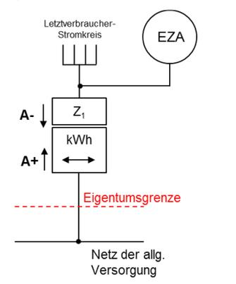
Einspeisung in die Kundenanlage ohne Erzeugungszähler, Eigenbedarfsdeckung
