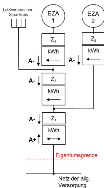
Einspeisung von zwei Erzeugungsanlagen mit unterschiedlichen Energieträgern in eine Kundenanlage, Eigenbedarfsdeckung, EEG-Umlage
