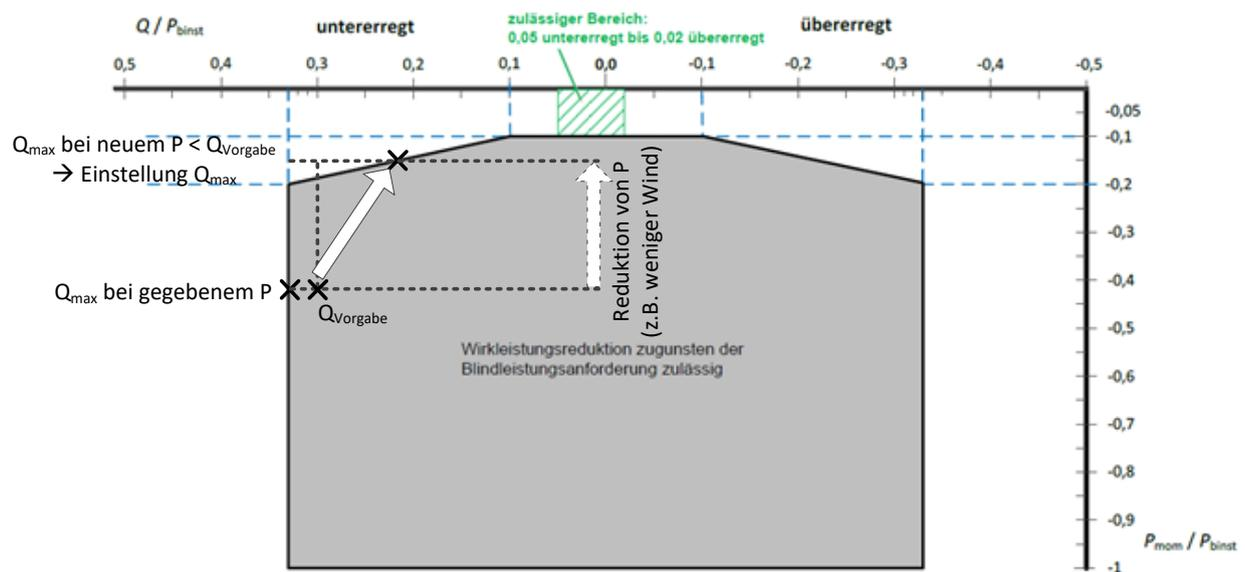
**Bild 2** Verhalten bei Überschreitung der Blindleistungsgrenze durch Wirkleistungsreduzierung ( $P_{\text{binst}} = P_{rA}$ )
