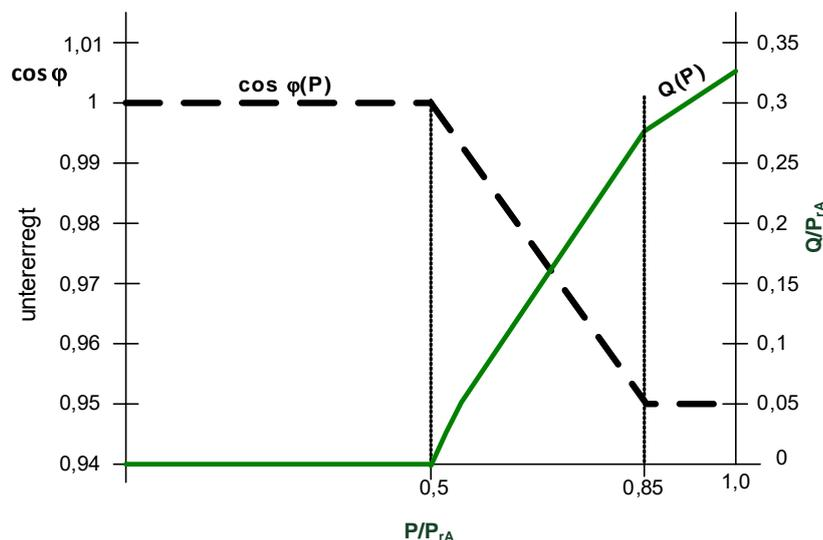
**Bild 1**  $Q = f(P/P_{rA})$ -Kennlinie für Erzeugungsanlagen mit  $P_{rA} \geq 135$  kW
