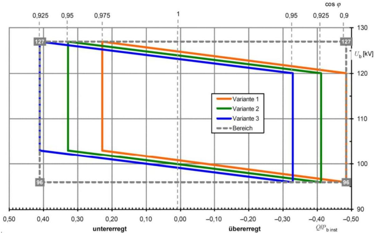
**Bild 1** Anforderung zur Blindleistungsbereitstellung am Netzanschlusspunkt für Erzeugungsanlagen am HS-Netz (VDE-AR-N 4120) → Umsetzung Variante 3
