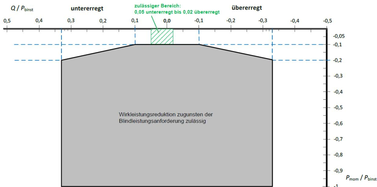
**Bild 1** Geforderter Stellbereich der Blindleistung für Erzeugungsanlagen mit  $P_{\text{binst}} = P_{rA} \geq 135$  kW (VDE-AR-N 4110)
