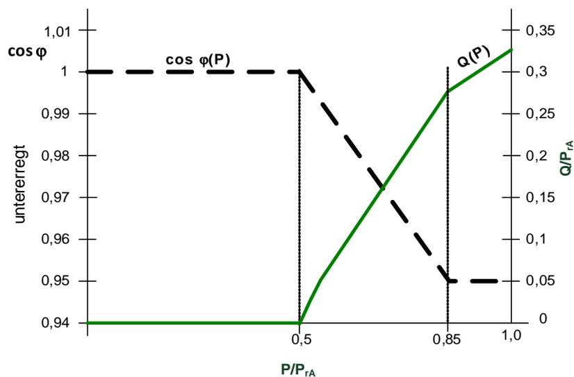
**Bild 1**  $Q = f(P/P_{rA})$ -Kennlinie für Erzeugungsanlagen mit  $P_{rA} \geq 135 \text{ kW}$
