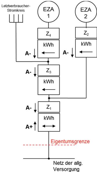
Einspeisung von zwei Erzeugungsanlagen mit unterschiedlichen Energieträgern in eine Kundenanlage, Eigenbedarfsdeckung, EEG-Umlage
