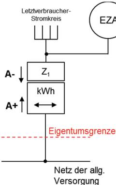
Einspeisung in die Kundenanlage ohne Erzeugungszähler, Eigenbedarfsdeckung
