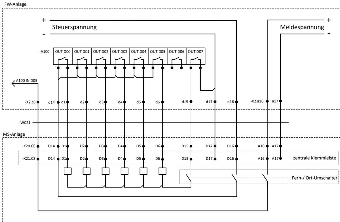
**Bild A.3.1 – 1,5-polige Steuerung**
