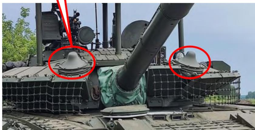
Рекомендуемые места установки антенных модулей на танке Т-80БВМ
