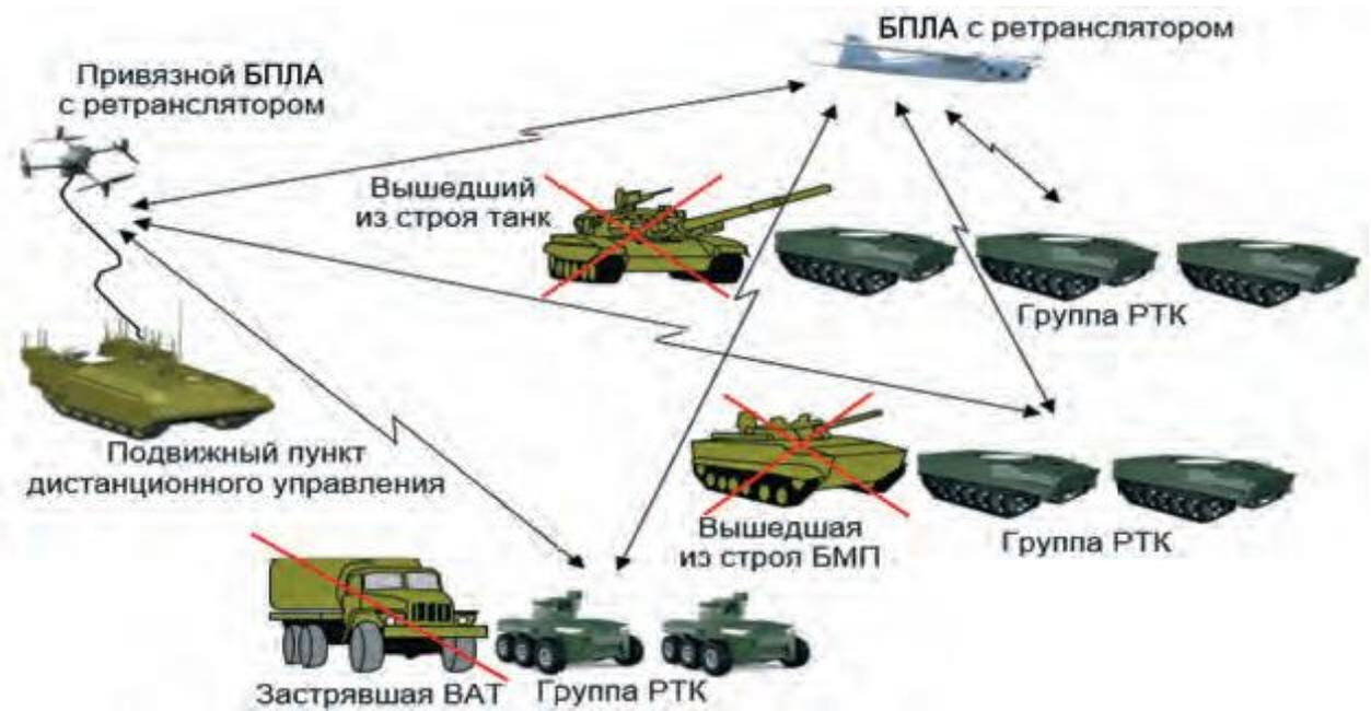
Рис. 4. Групповое применение РТК при эвакуации ВВСТ (вариант)
