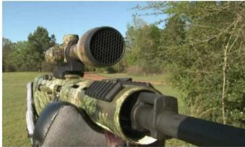
Նկ. 4 Ժամանակակից բջջավոր բլենդայի տեսակ, որն օգտագործվում է դիպուկահար հրացանի օպտիկական սարքի վրա
