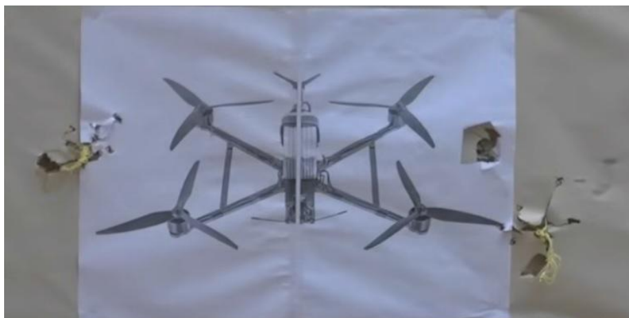
Фото 17. тестировщиками сделано 2 выстрела с расстояния 5 метров с целью показа диаметра раскрытия патрона
