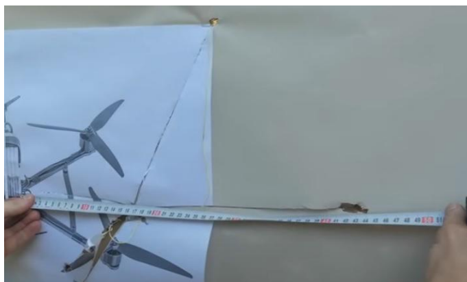
Фото 22. показ раскрытия поражающих элементов на расстоянии 20 метров (составляет 43 см)
