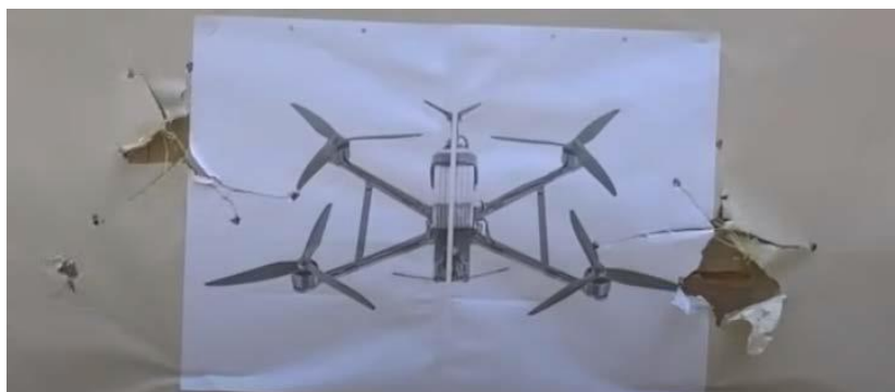
Фото 19. тестировщиками сделано 2 выстрела с расстояния 10 метров с целью показа диаметра раскрытия патрона
