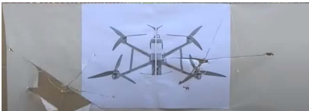
Фото 21. 2 выстрела с расстояния 20 метров с целью показать диаметр раскрытия патрона, произведенные тестировщиками
