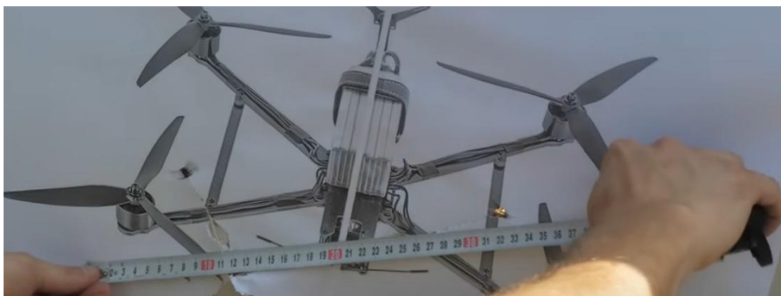
Фото 24. Показ раскрытия поражающих элементов на расстоянии 30 метров (составляет 33 см)
