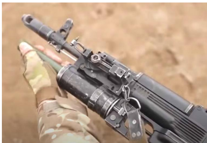
Фото 7. Момент снаряжения устройства в подствольный гранатомет «ГП-25»
