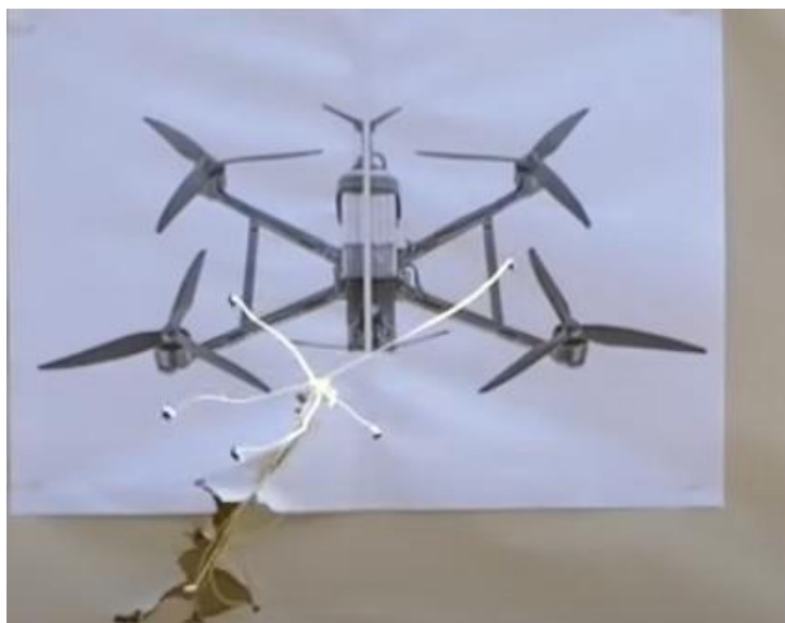
Фото 23. Визуализация момента раскрытия поражающего патрона на расстоянии 30 метров
