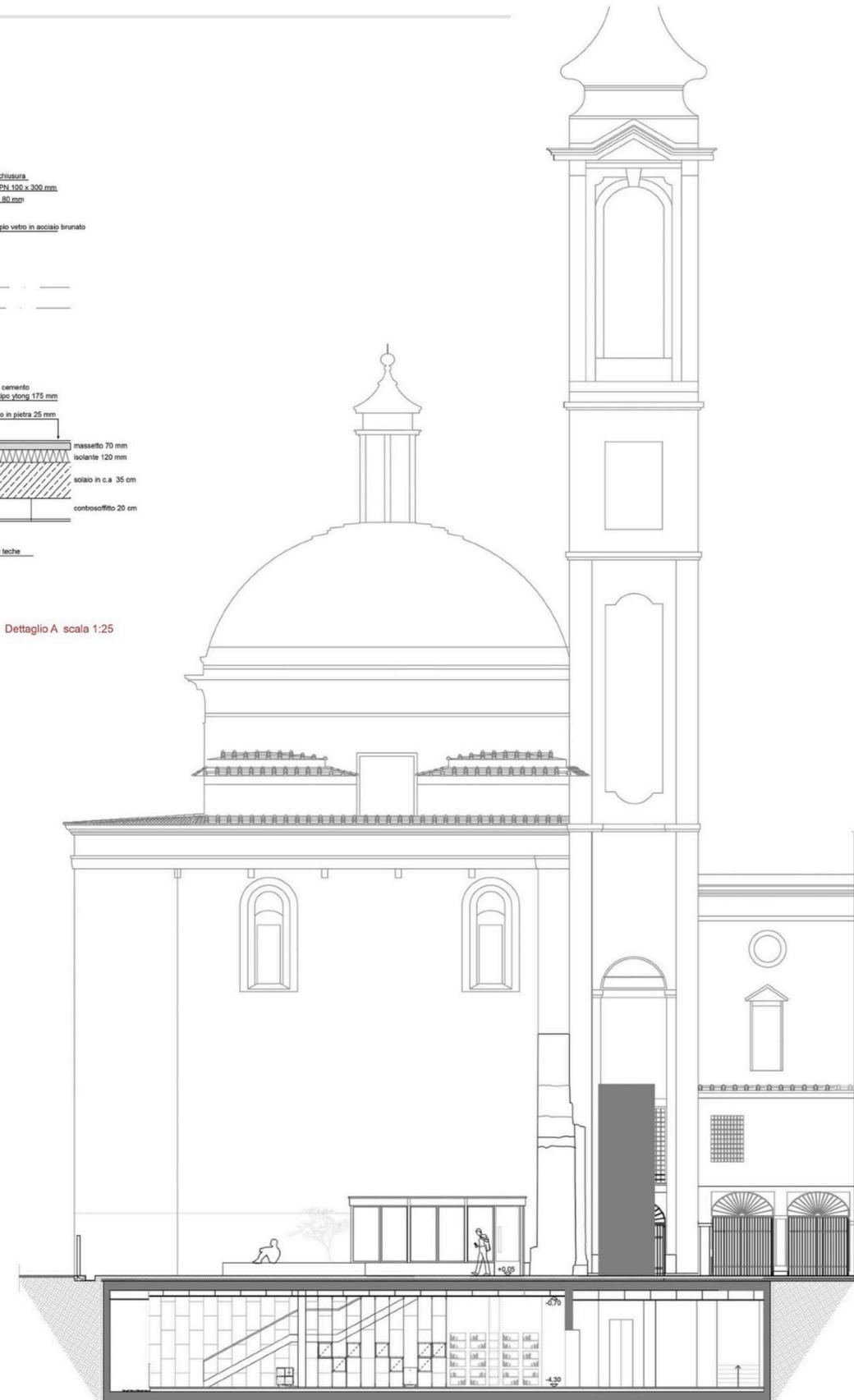
Sezione prospetto longitudinale A A scala 1:100
