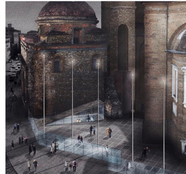
1. pavimentazione in calcestruzzo architettonico tipo "sica" a grangola sottile nelle tonalità di marrone chiaro e scuro, trattato superficialmente con cura naturale protettiva.
