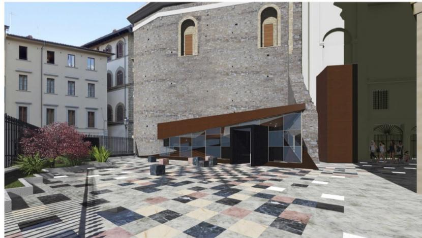
Il pavimento della corte antistante l'uscita ripropone il disegno pavimentale della Sagrestia Nuova attraverso la stesura di lastre matericamente e cromaticamente simili a quelle poste in opera in Sagrestia
