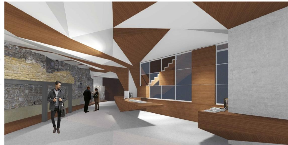
L'idea generale della proposta nasce dal rivestimento del pilastro esistente con pannellature in legno, simbolicamente un fusto d'albero dal quale dipartono al livello del solaio i controsoffitti modulati come fossero i rami e la chioma, utili a contenere le canalizzazioni di servizio e diversificati tra la finitura in pannelli di legno e le finiture in tinta.
