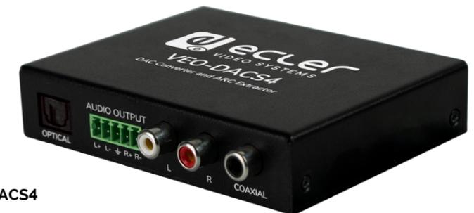
VEO-DACS4 permite convertir las señales de audio digital de las entradas HDMI ARC, S/PDIF óptico o coaxial a una señal analógica estéreo. Además, puede utilizarse para direccionar el audio digital S/PDIF del conector óptico al coaxial y viceversa. Proporciona una salida analógica estéreo no balanceada con conectores Euroblock y RCA. El modo de funcionamiento se puede seleccionar a través del interruptor incorporado.
