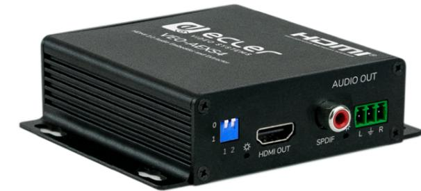
VEO-AEXS4 permite extraer o embeber el audio de señales HDMI 2.0 con resolución de hasta 4K. Incorpora una entrada y una salida analógica estéreo no balanceada con conectores Euroblock y una salida digital S/PDIF con conector coaxial. El modo de funcionamiento se puede seleccionar mediante el interruptor DIP integrado.
