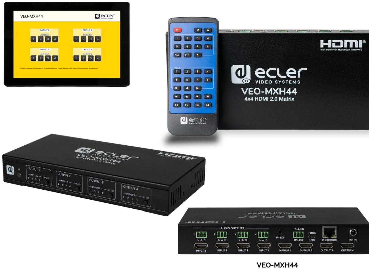
Ecler VEO-MXH44 es una matriz HDMI 4x4 compatible con señales de alto rango dinámico (HDR). La selección de HDMI puede ser manual a través del panel frontal, a través del mando a distancia o remota a través de comandos de serie, TCP / IP. La interfaz gráfica web integrada permite configurar y controlar la unidad fácilmente.
