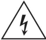
Das Blitzsymbol mit Pfeil im gleichseitigen Dreieck soll den Benutzer vor nicht isolierter, gefährlicher Spannung im Gerät warnen, die hoch genug ist, um einem Menschen einen Stromschlag zu versetzen.
