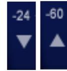
Cuando el botón tiene la forma de un triángulo apuntando hacia abajo, el rango de ganancia es entre +12dB y -30dB. Cuando el botón tiene la forma de un triángulo apuntando hacia arriba, el rango es entre +12dB y -72dB.
