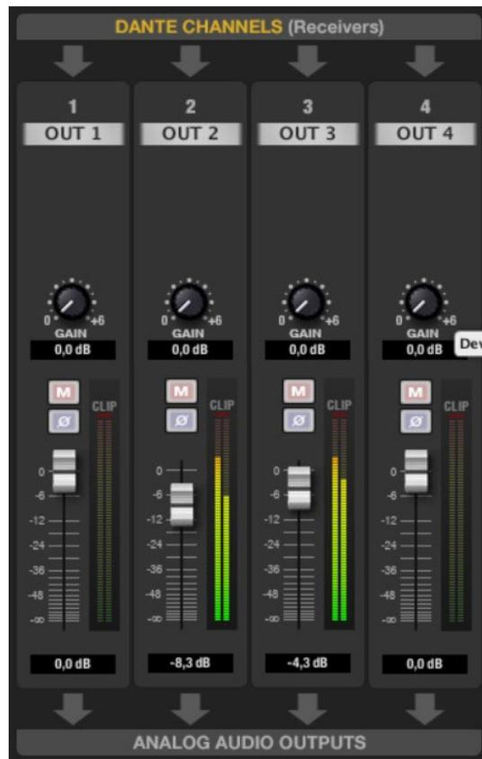
Muestra los controles y parámetros de las 4 señales de audio analógicas que la unidad entrega en los conectores balanceados del panel posterior, las cuales toman su contenido de 4 canales Dante recibidos desde la red mediante la interfaz Ethernet RJ45:
