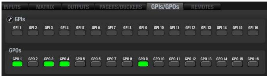
Los puertos GPI y GPO permiten conectar el MIMO88 a elementos de control externos físicos e interactuar con ellos: potenciómetros, pulsadores, interruptores de fin de carrera, luces, motores, etc.
