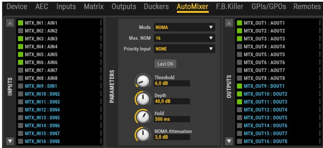
El módulo de procesamiento AUTOMIXER utiliza un algoritmo muy sofisticado para gestionar qué señales de entrada deben formar parte de la mezcla automática y bajo qué condiciones, y qué señales deben permanecer separadas. El AUTOMIXER analiza el contenido de audio de todas las entradas para identificar lo que debe considerarse como ruido de fondo y lo que debe considerarse como una señal válida para activar el canal de entrada en la mezcla automática.
