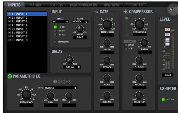
En la parte superior izquierda de la sección se encuentra una lista de las entradas de la unidad, mostrando desde 8 entradas (configuración 8x8, todos los canales en mono), hasta 16 entradas (configuración 16x16, todos los canales en mono), pasando por todas las combinaciones posibles de parejas de canales estéreo combinadas con canales mono.
