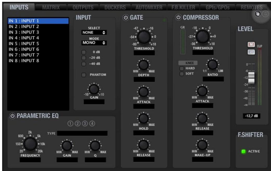
Comparándola con la misma sección de la versión MIMO88 estándar, se aprecia que no existe el ajuste de retardo (DELAY) para cada entrada, pese a que se han mantenido los ajustes de retardo en cada una de las salidas de la unidad.
