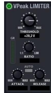
En dicho modo el umbral de limitación aparece con sus unidades en Volts y los controles **RATIO**, **ATTACK** y **RELEASE** son inhabilitados.
