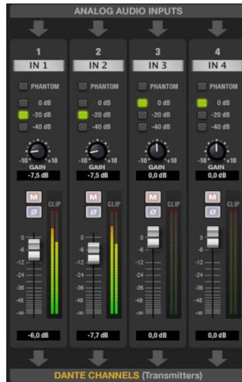
La ventana muestra los controles e indicadores de las 4 entradas analógicas que la unidad recibe en sus terminales balanceados del panel posterior, y que son convertidas a 4 canales Dante:
