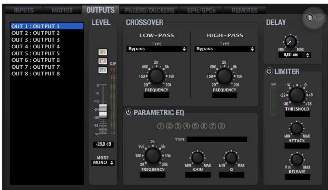
En la parte superior izquierda de la sección se encuentra una lista de las salidas de la unidad, mostrando desde 8 salidas (configuración 8x8, todos los canales en mono), hasta 16 salidas (configuración 16x16, todos los canales en mono), pasando por todas las combinaciones posibles de parejas de canales estéreo combinadas con canales mono.
