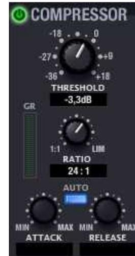
Ajustar correctamente los tiempos de **ATTACK** y **RELEASE** de los compresores no es una tarea sencilla: usar tiempos de ataque o relajación demasiado rápidos causa una distorsión perceptible y excesiva en bajas frecuencias; usar por el contrario tiempos demasiado lentos podría hacer inútil un limitador, ya que cuando vaya a actuar ya se puede haber producido el daño.
