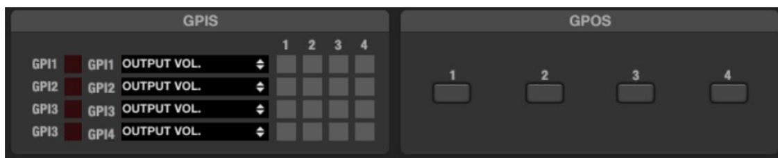
Los puertos **GPI** de la unidad (puertos de control 0 – 10 VDC) del panel posterior se encuentran representados como GPI 1 al 4. A la derecha de cada uno de ellos se muestra el valor de lectura en tiempo real de la señal captada en el pin central de cada puerto GPI (escalada de 0 a 100). Un panel tipo *WPmVOL / WPaVOL* o *WPmVOL-SR / WPaVOL-SR* conectado a un puerto GPI, entregará valores dentro de ese rango al actuar sobre su control giratorio.
