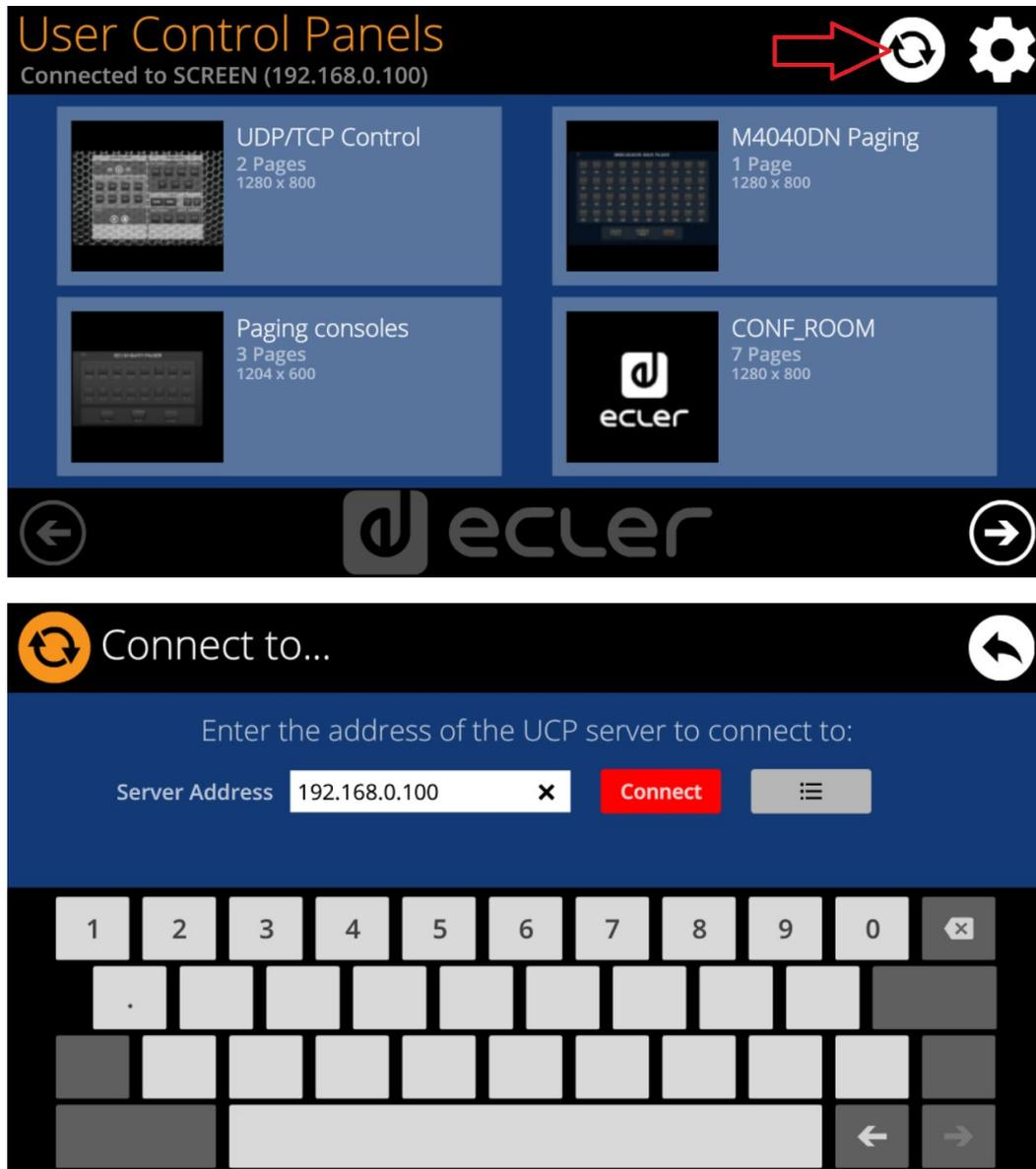
Esta página permite decidir el servidor UCP al que se conectará la unidad como cliente. El servidor UCP puede ser un ordenador, una matriz MIMO404040DN (¡sí, tiene un servidor UCP integrado en su motor!), otra unidad WPNETTOUCH / WPmSCREEN / PAGENETDN o incluso la misma unidad WPNETTOUCH. En cualquier caso, el servidor UCP alojará y ejecutará un proyecto EclerNet Manager que incluye una serie de UCPs que pueden ser gestionados de forma remota por cualquier cliente UCP.
