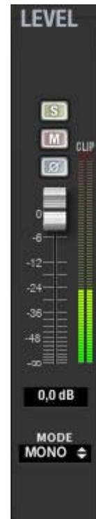
Si, además del modo estéreo se activa el modo **Link channels** desde la sección **MATRIX** (símbolo de eslabones de cadena), también los 2 puntos de cruce entre la entrada y la salida afectadas sincronizarán sus niveles y función de mute (ver ejemplos en [Columna INPUTS](#))
