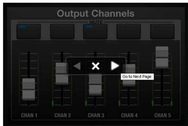
Un doble clic sobre una parte en blanco de la pantalla muestra las teclas de desplazamiento derecha e izquierda, así como el símbolo X, que se emplea para volver a la pantalla raíz de los paneles disponibles en el proyecto (misma función que la tecla ESC)
