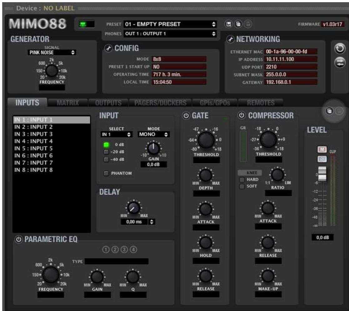
Existen dos partes diferenciadas. Una sección superior destinada a la configuración y ajustes generales de la unidad, y una serie de pestañas en la parte inferior (INPUTS, MATRIX, OUTPUTS, etc.) para mostrar las diferentes secciones de la programación del dispositivo.
