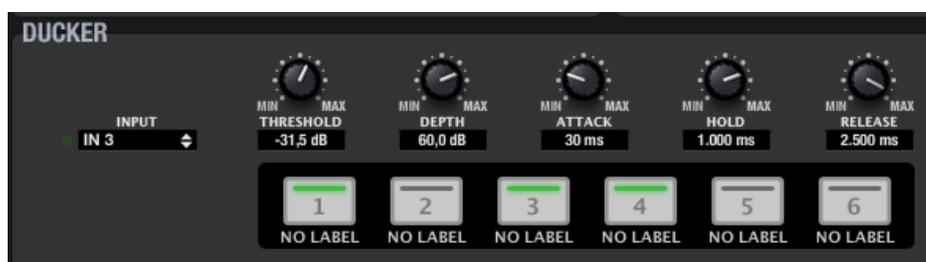
Mediante el selector INPUT se define a qué entrada de audio del MIMO88 se conectará el micrófono, reproductor de audio u otra fuente sonora que actúe como disparador de la función DUCKER. La lista muestra las 4 ó 6 posibles entradas del dispositivo, según modelos.
