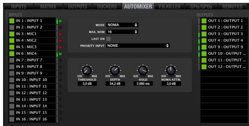
El módulo de procesamiento AUTOMIXER emplea un algoritmo muy sofisticado para gestionar qué señales de entrada y en qué condiciones deben formar parte de la mezcla automática y qué señales deben permanecer al margen. AUTOMIXER analiza el contenido sonoro presente en todas las entradas para discriminar qué debe ser considerado ruido de fondo y qué debe ser considerado una señal válida para disparar el canal de ingreso en la mezcla automática.
