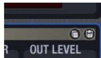
Pulsando sobre “Copy Channel Data” en un canal (canal de origen) se almacenan todos sus parámetros en una memoria temporal.
