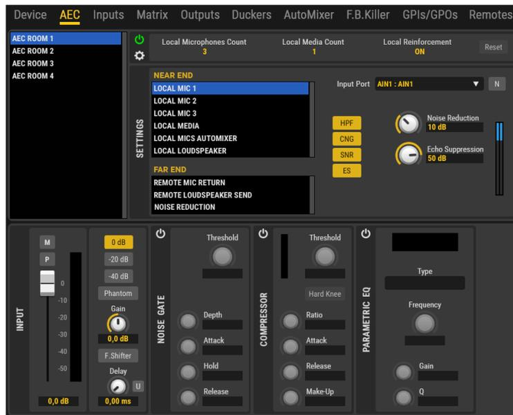
Seleccionando cada micrófono local en la ventana de AJUSTES NEAR END, es posible definir el enrutamiento y el procesamiento de la señal del micrófono procesada por el algoritmo AEC.
