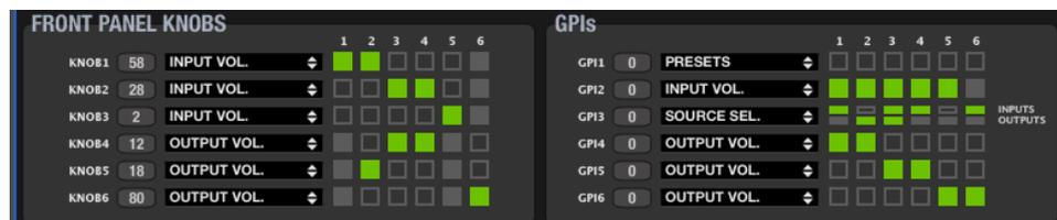
Los controles LEVEL del panel frontal se encuentran representados como KNOB 1 al 4 (o 1 a 6, en función de modelos). A la derecha de cada uno de ellos se muestra el valor de lectura en tiempo real (=posición de control) del control LEVEL físico del panel frontal, en una escala de 0 a 100 (en el ejemplo 58, 28, 2, etc.)
