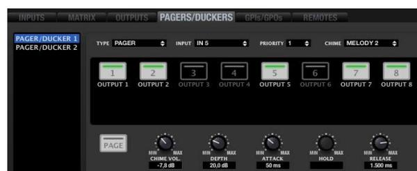
Detalle de la sección PAGERS/DUCKERS, desde la que se configura la funcionalidad de una unidad MPAGE16 conectada al sistema
