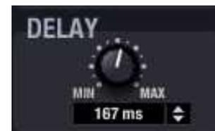
El tiempo de retardo puede ser especificado en distintas unidades, que se seleccionan mediante el parámetro **UNITS**. Las posibles unidades son milisegundos, segundos, centímetros y metros. El **DELAY** puede ser ajustado entre 0 y 1000 milisegundos.
