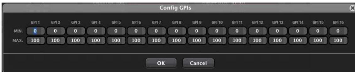
Ejemplo para calibrar un potenciómetro físico WPVOL conectado al GPI nº2 y que será empleado para gestionar remotamente un control de volumen del MIMO88:
