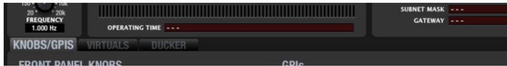
La sección **KNOBS/GPIs** permite configurar la función de los controles giratorios LEVEL del panel frontal, así como la función de los puertos GPI de control remoto, 0-10 VDC, del panel posterior.
