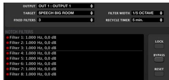
Los filtros dinámicos pueden ser reposicionados a lo largo del tiempo si el algoritmo detecta que es necesario (micrófonos que se mueven en la sala, cambios en las condiciones acústicas, etc.).
