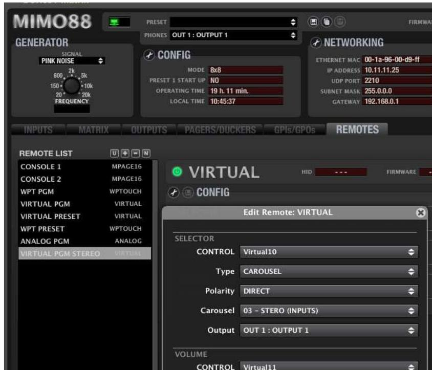
El selector virtual de la imagen anterior, creado en la sección REMOTES de un MIMO88, puede ahora ser controlado remotamente desde un UCP:
