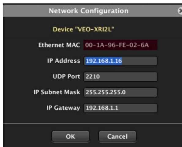
Si se diera el caso de que alguno de los equipos no pertenece a la red de trabajo, se deberá configurar el ordenador de control en el rango de red del dispositivo en cuestión y repetir el proceso para modificar la dirección IP del equipo al rango deseado.
