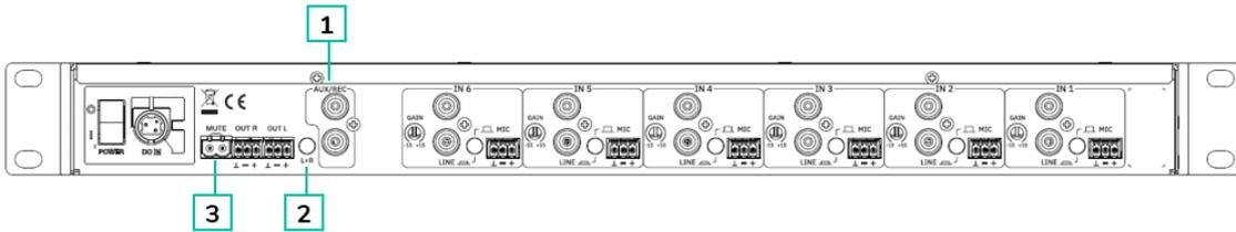
1. **Sortie auxiliaire ou d'enregistrement AUX/REC** à niveau nominal de 0 dBV sous charge de 10 kΩ. Elle dispose d'un réglage de gain supplémentaire de +6 dB, activable par cavalier interne (par défaut en position 0 dBV).
