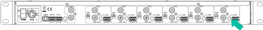
**Signal de microphone** : les 6 voies de mixage disposent d'une connexion de type Euroblock et sont prévues pour un niveau nominal d'entrée de  $-50$  dBV (3,16 mV) à  $-20$  dBV (0,1 mV), avec un gain réglable au moyen de la commande GAIN de la face arrière.
