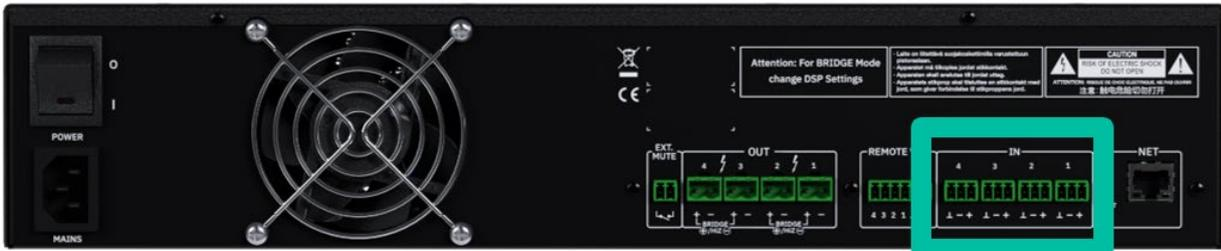
Los conectores de entrada de señal son bloques de terminales de tornillo de 3 posiciones. El cableado es:
