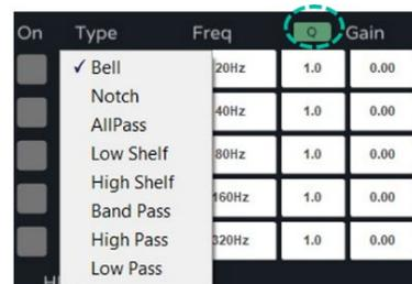
Cada filtro se puede activar y desactivar mediante el botón ON
