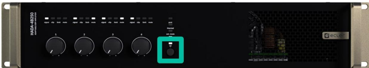
**Para entrar en modo de reposo**, mantenga pulsado el botón ON hasta que todos los LEDs del panel frontal parpadeen una vez. El LED prot. (rojo) se iluminará junto con el LED ON (blanco) para indicar que el modo de espera está activo.
