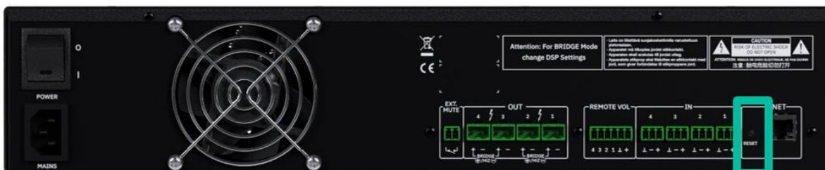
En caso de que haya configurado una dirección de red fija y la haya olvidado, si mantiene pulsado el botón de reinicio durante más de 10 segundos podrá configurar la interfaz de red en modo DHCP como de fábrica. De este modo, utilizando el software HADA DSP Manager en un PC con su tarjeta de red configurada como cliente DHCP, será posible detectar el amplificador y cambiar de nuevo la configuración de red.
