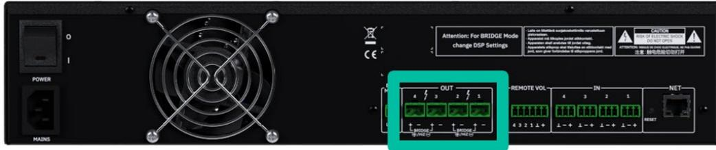
**!** Respete siempre la polaridad relativa de las salidas (+ y - en cada conector de conector de salida), del cableado y de los altavoces.
