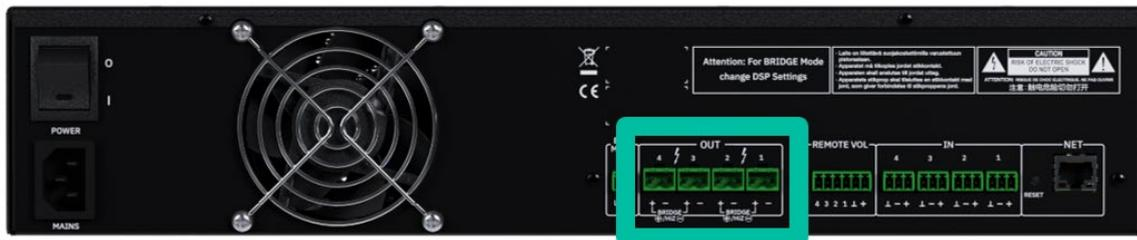
**!** Respectez toujours la polarité relative des sorties (+ et – sur chaque connecteur de sortie), du câblage et des enceintes.
