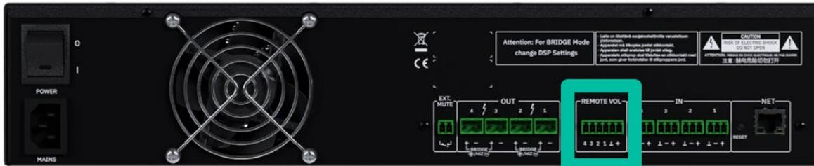
Lorsque ces entrées GPI sont utilisées en combinaison avec les potentiomètres de la face avant, c'est la valeur la plus basse des deux qui définit le niveau de sortie maximal.
