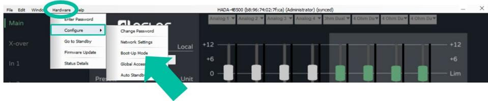
Par défaut, l'option sélectionnée est Last Setting (dernier réglage), qui fait redémarrer l'appareil avec le dernier réglage en vigueur au moment de l'extinction.
