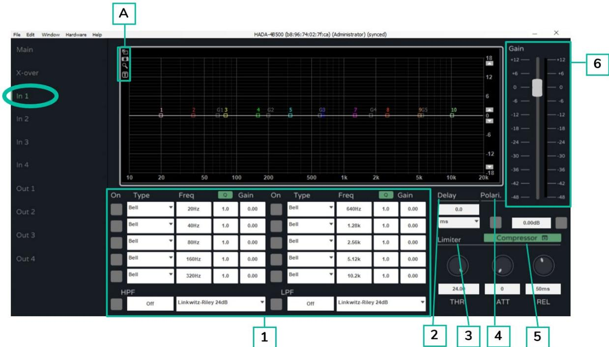
En plus des 10 filtres paramétriques, un filtre passe-haut (HPF) et un filtre passe-bas (LPF) sont disponibles sur chaque entrée. Ils peuvent être des types suivants :
