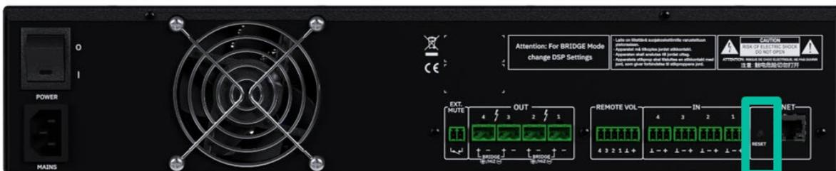
Si vous avez défini une adresse réseau fixe et l'avez oubliée, maintenir le bouton de réinitialisation enfoncé pendant plus de 10 secondes permet de reconfigurer l'interface réseau en mode DHCP comme à sa sortie d'usine. De cette façon, en utilisant le logiciel HADA DSP Manager sur un ordinateur dont la carte réseau est configurée comme client DHCP, il sera possible de détecter l'amplificateur et de modifier à nouveau ses paramètres réseau.
