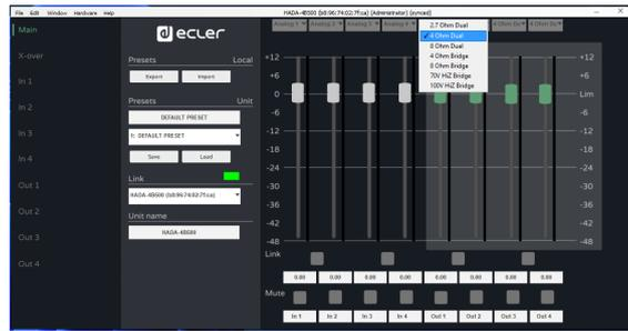
Lorsqu'une paire de canaux est configurée en mode Bridge, les canaux d'entrée 1 et 3 servent de source et les faders de sortie 1 et 3 agissent comme commande de volume pour la paire bridgée, de même que les potentiomètres de sortie 1 et 3 en face avant de l'amplificateur. Les entrées, les faders de sortie et les potentiomètres 2 et 4 n'ont pas d'effet sur les sorties bridgées.
