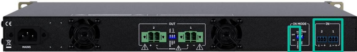
Die Signaleingangs-Anschlüsse sind als 3-polige Schraubklemmenblöcke ausgeführt. Die Pinbelegung sieht wie folgt aus:
