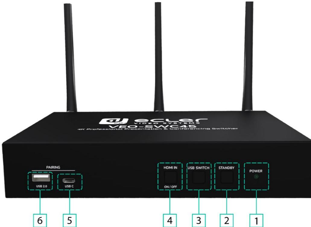
1. **Power LED (LED de encendido):** se ilumina en verde cuando el dispositivo está encendido y en rojo cuando está apagado.
