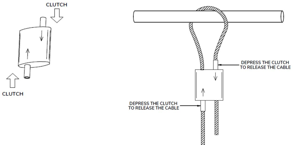
2. Cuelgue el GLOBE del techo, enganche el cordón de seguridad y conecte el cable de corriente
