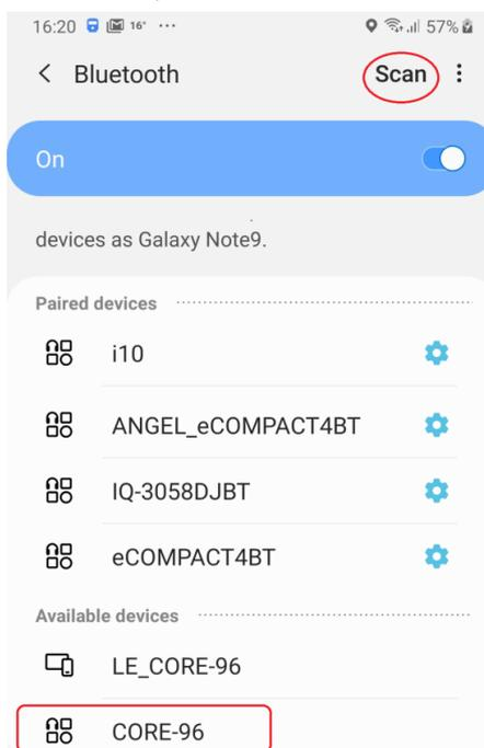
2. El dispositivo maestro debe ser descubierto y aparecer en la lista como CORE-XX, donde XX coincide con los 2 últimos dígitos de la dirección MAC de cada unidad. Este es el Alias del dispositivo por defecto, o ID de los dispositivos Master, y puede ser modificado más tarde usando la aplicación
