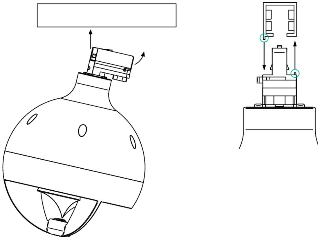
Conexión a un carril de iluminación GLOBAL Trac Pro / Eutrac (sistema de carril de iluminación de tres circuitos)
