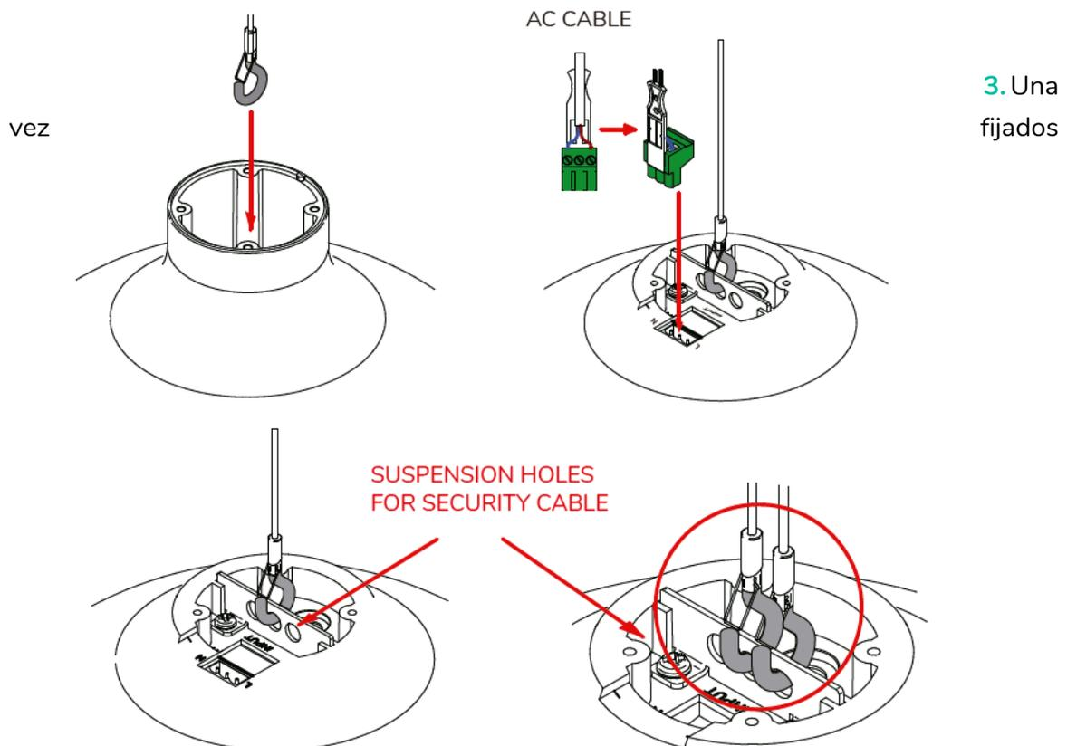
los cordones de seguridad y el cable, coloque la tapa superior del conexionado.
