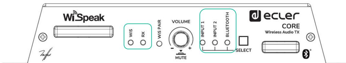
Los LEDs del panel frontal proporcionan información sobre el estado de funcionamiento de la unidad y la fuente seleccionada actualmente.
