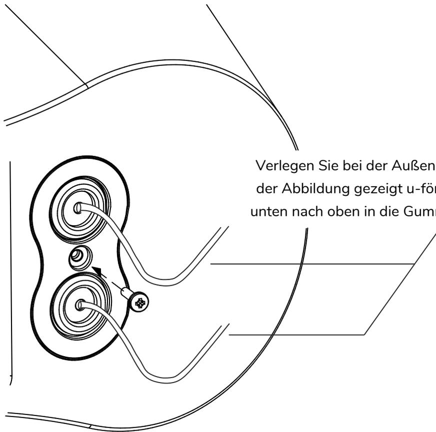
Verwenden Sie bei der Außeninstallation ein rundes Werkzeug, um Löcher in die Tüllen zu Gummitülle. Vermeiden Sie gerade Schnitte. Achten Sie außerdem darauf, dass Sie runde Kabel statt paralleler Kabel verwenden.
