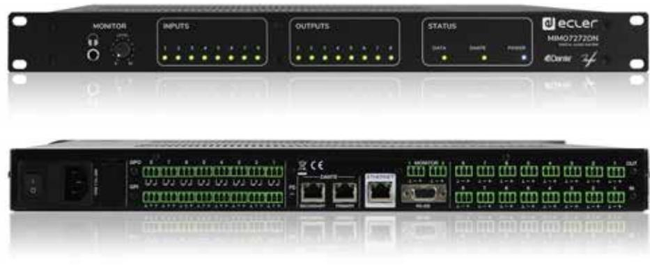
**MIMO7272DN** ist eine digitale Matrix mit nativer 64x64-Verarbeitung. Sie verwendet das Audioprotokoll über IP Dante/AES67 zur Übertragung von Kanälen über lokales Standard-Ethernet, so dass Abstandsbeschränkungen überwunden werden und die Verkabelung der Anlage
