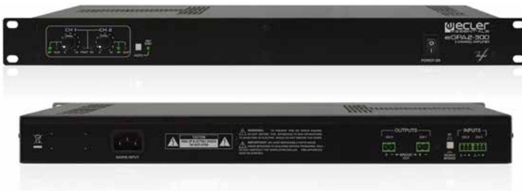
eGPA2-300 ist ein Mehrkanal-Hochleistungsverstärker (Klasse D) mit 2x300W RMS an 4 Ohm. Er hat Auto-Standby-Funktion (geht im Ruhezustand automatisch in den Energiesparmodus) und arbeitet, dank des Verzichtes auf Zwangsbelüftung (kein Ventilator), 100% geräuschlos. Überhitzungs- und Überlastungsschutz. Mit Anti-Clip-System.
