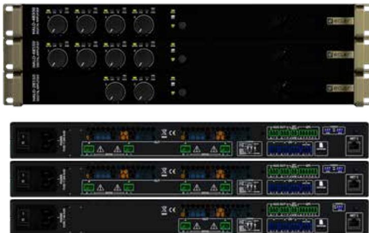
**Ecler HALO** ist eine Serie von Mehrkanal-Endstufen mit netzwerkbasierendem DSP. Die Produktlinie umfasst Modelle mit 2 und 4 Ausgängen, die sowohl für nieder- als auch hochohmige Anwendungen geeignet sind. Brückenbetrieb zwischen Ausgängen ist im hochohmigen Modus oder zur Leistungsverdopplung im niederohmigen Modus möglich. Die integrierte Weboberfläche (ähnlich wie bei der VIDA-Serie) ermöglicht eine einfache Programmierung und
