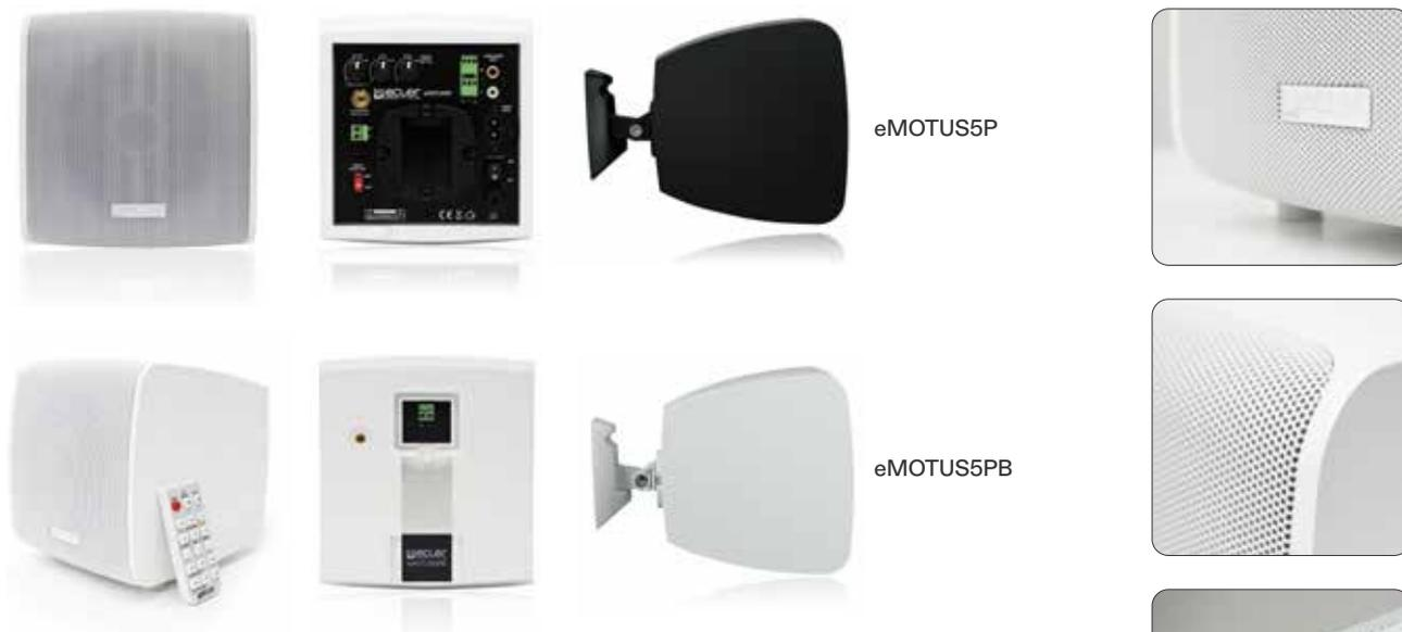
**eMOTUS5P / eMOTUS5PB** sind 5“-Lautsprecher-Sets bestehend aus einer aktiven und einer passiven Lautsprecherbox. Das Set **eMOTUS5PB** ist zusätzlich noch mit einem drahtlosen BT-Empfänger, einer Fernbedienung und einem Eingang zur Lautstärkeeinstellung per Fernbedienung (0-10VDC) ausgestattet. Der **eMOTUS5PB** ist in Weiß (RAL9003) erhältlich, während der **eMOTUS5P** sowohl in Weiß (RAL9003) als auch in Schwarz (RAL9005) verfügbar ist.
