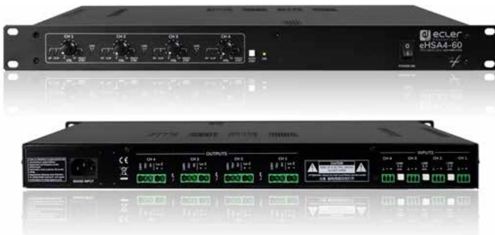
**eHSA4-60** ist ein 4x60W Mehrkanal-Verstärker, der sowohl in niederohmigen als auch in hochohmigen Lautsprecherlinien eingesetzt werden kann (8/4Ω bzw. 70/100V). Er bietet die Möglichkeit, die Eingangskanäle miteinander zu verbinden, so dass ein Eingangssignal ganz leicht an mehrere oder an alle Ausgangskanäle verteilt werden kann.
