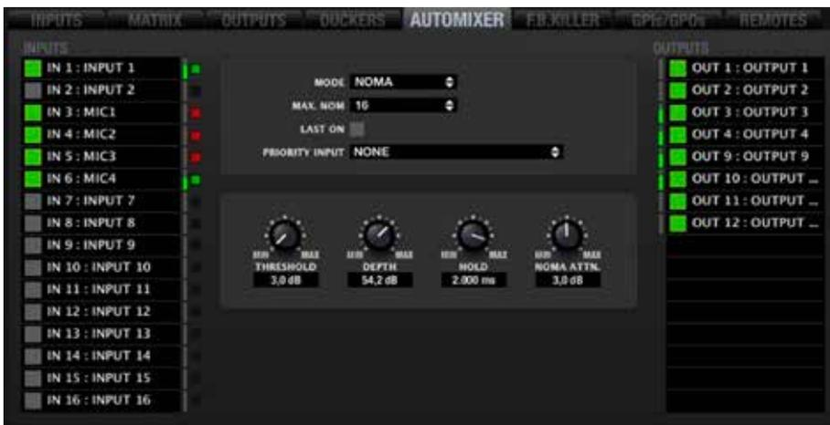
**MIMO CONFERENCE** wurde speziell für Anwendungen entwickelt, bei denen Konferenzschaltungen, automatischer Mikrofonmix und die Unterdrückung von Rückkopplungsschleifen (Larsen-Effekt) vorkommen. Die MIMO Conference hat die gleiche Hardware wie die Standardversion der MIMO und verfügt zusätzlich über ein spezielles Firmware-Upgrade mit maßgeschneiderten DSP-Ressourcen für Automix und Konferenzzwecke. Firmware im EclerNet Manager-Paket enthalten. Kompatibel mit MIMO88, MIMO88SG und MIMO1212SG.
