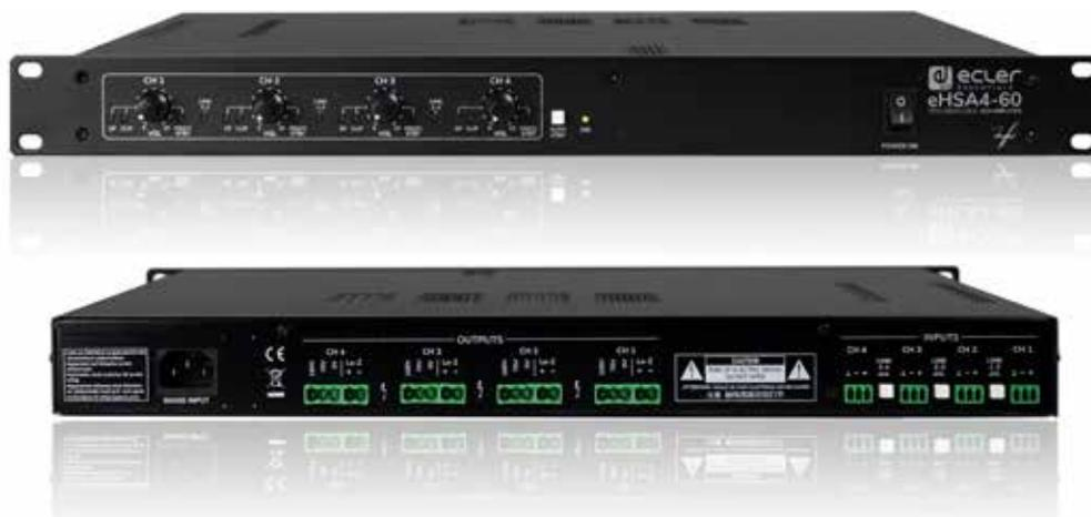
**eHSA4-60** es un amplificador multicanal de 4×60W capaz de trabajar tanto en líneas de baja impedancia (8 / 4 Ω) como en líneas de alta impedancia (70/100V). Dispone de la capacidad de enlazar los canales de entrada, de modo que se puede distribuir de forma sencilla la misma señal de entrada a varios o todos los canales de salida. Función auto standby independiente por canal.
