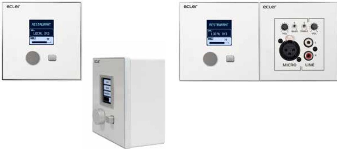
**eMCONTROL1** es un panel digital de control para los gestores de zona de la serie HUB con formato mural. Acoplado a un panel tipo WPa con conector de audio: la pareja se comporta como un único panel que proporciona control remoto + envío directo a la unidad HUB de una señal de audio balanceada, empleando para ello un único cable tipo CAT5e o superior conectado punto a punto.
