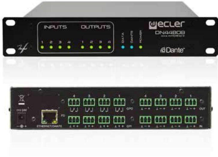
**DN44BOB** es una interfaz de audio sobre IP que emplea el protocolo Dante/AES67, que permite convertir 4 señales de audio analógicas MIC/LINEA en 4 canales Dante para su transmisión vía red Ethernet, así como la recepción de 4 canales Dante desde la red Ethernet y su conversión en señales de audio analógico y nivel LINEA.
