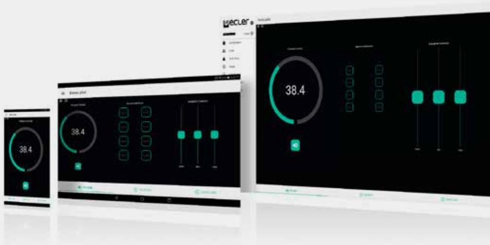
**Ecler pilot** es una aplicación para el control remoto por parte del usuario final sobre una a más zonas de la instalación, accediendo mediante su cuenta de usuario a los paneles de control que le han sido asignados. Cada panel de control de usuario puede incluir controles de volumen & mute y/o selección de fuentes musicales y/o ajuste de tonos (EQ) de tres bandas.
