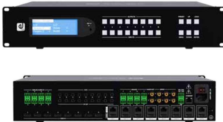
Matriz 8×8 HDBaseT y HDMI® diseñada para instalaciones AV profesionales que requieren una distribución flexible de señales 4K. Ofrece extensión de vídeo a larga distancia, gestión de audio integrada y configuración sencilla para el usuario. Con avanzadas capacidades de enrutamiento y soporte para alimentación a través del cable, es una solución inteligente y eficiente para entornos complejos de vídeo y audio.
