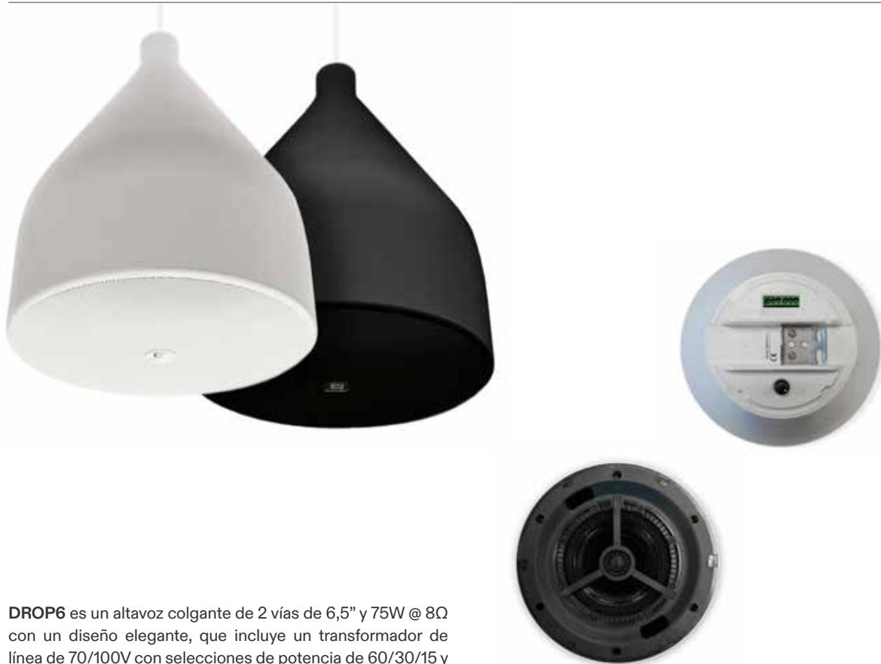
**DROP6** es un altavoz colgante de 2 vías de 6,5" y 75W @ 8Ω con un diseño elegante, que incluye un transformador de línea de 70/100V con selecciones de potencia de 60/30/15 y 7,5W, disponible en niveles de alta y baja impedancia.
