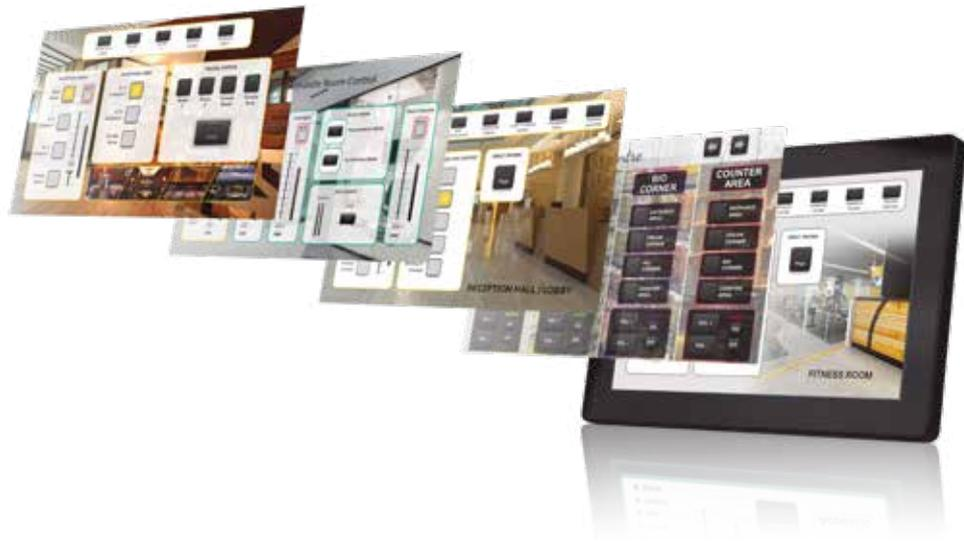
**WPNETTOUCH** es un panel táctil TFT de control remoto compatible con todos los productos EclerNet. Cada unidad puede ser configurada para actuar como panel de control de una zona de control local, o como un control global multi-zona. Permite ejecutar paneles de control incluyendo ajustes de volumen, selección de fuentes musicales, recuperación de presets, comunicación con otros equipos externos vía TCP/UDP, etc.
