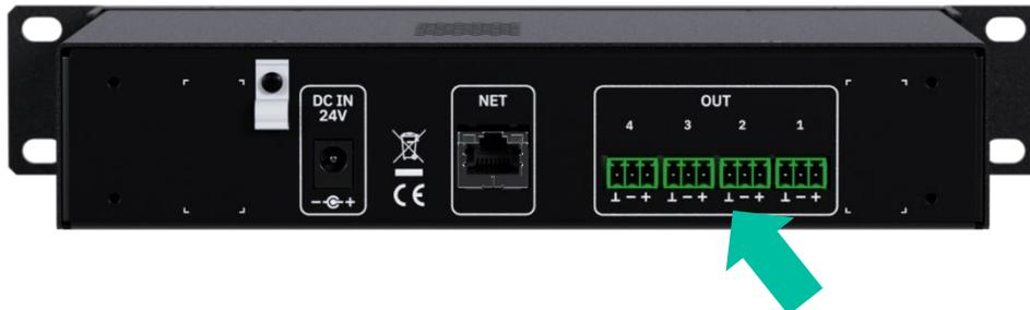
Die Signalausgangs-Anschlüsse sind als 3-polige Schraubklemmenblöcke ausgeführt. Die Pinbelegung sieht wie folgt aus:
