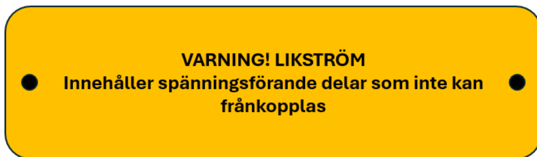
Figur 14. Markering för dolt förlagd likströmskabel. Anammat från [19].
