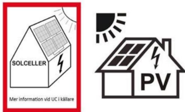
Figur 15. Exempel på två olika sorters skyltning för att tydliggöra att solceller finns i byggnaden från SEK Handbok 457 [19].
