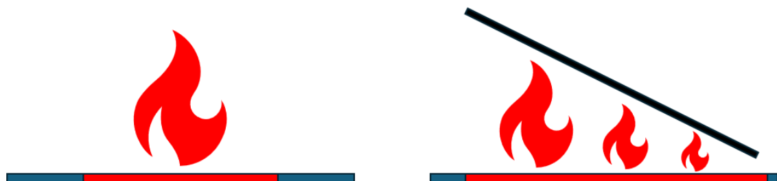
Figur 8. Illustrativ jämförelse mellan en friliggande brand på ett tak och en brand under en solpanel. Röd markering indikerar en illustrativ jämförelse i delar av taktäckningen som involveras i branden.
