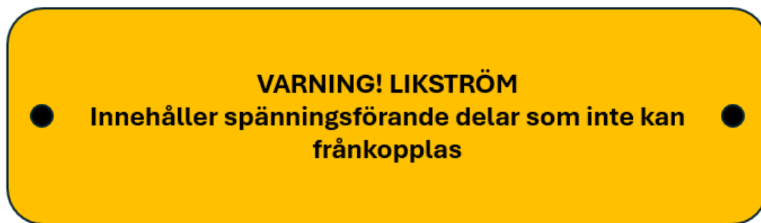
Figur 18. Markering för dolt förlagd likströmskabel. Anammad från [19].
