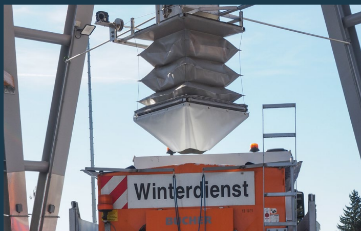
ENTNAHME SILO VOLLAUTOMATIK
