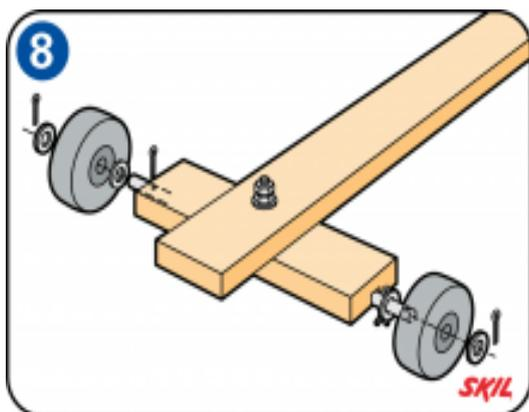
Les deux trous percés aux extrémités des essieux (tiges métalliques) accueillent des goupilles fendues qui, avec les deux rondelles, maintiendront les roues en place. S'assurer que les roues tournent librement. Ne pas manquer de graisser les deux extrémités des essieux pour limiter l'usure. Il est bon de graisser à nouveau au bout de quelques semaines. Si les roues sont dotées de pneus gonflables et non pas pleins, il est préférable de situer les valves côté longeron central.
