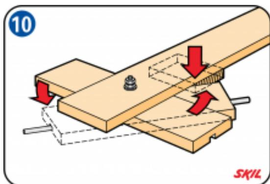
La butée destinée à limiter le pivotement de l'élément transversal avant se fixe sous le longeron central. Elle évite à l'essieu avant de braquer de manière excessive, ce qui pourrait provoquer un accident ou blesser le pied de la/du pilote.
