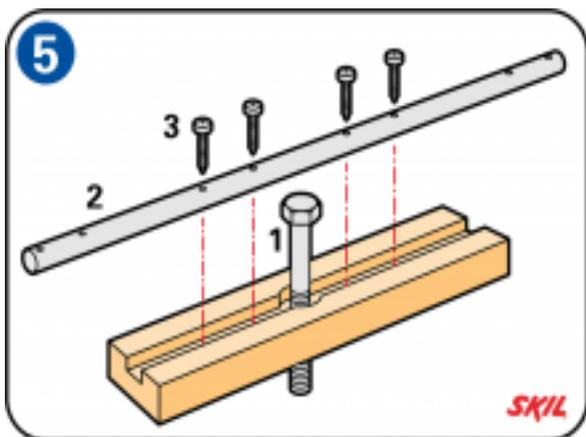
Passons à l'essieu avant de la caisse à savon. La marche à suivre est la même que pour l'essieu arrière, mais il faut commencer par poser le boulon M12 long de 12 ou 16 cm. Percer un trou de 12 mm au centre de l'élément transversal avant. À l'aide d'un foret de 20 mm, repercer sur environ 30 mm : cela permettra de noyer la tête du boulon M12 dans le chevron.
