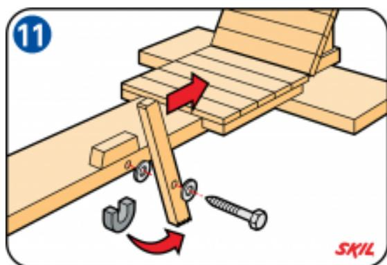
Le frein est un liteau pivotant dont la partie devant entrer en contact avec le sol a été rainurée ou garnie d'un fragment de pneu de voiture pour lui éviter une usure précoce.
