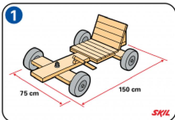
La caisse à savon est longue d'environ 1,2 à 1,5 m et large d'environ 0,75 m. Sa hauteur sera fonction du diamètre des roues. Plus les roues seront grandes, plus la garde au sol sera importante. Les dimensions sont aussi fonction de la taille du/de la pilote. Adaptez-les en fonction des circonstances. Il en va de même des matériaux du châssis, des roues, de la direction, du ou des freins, du siège...
