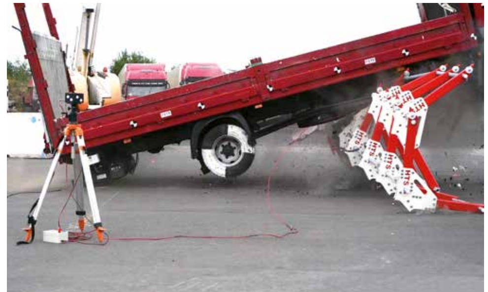
Konzeptgetreu wird die erste Reihe HTS auf die verbundene hintere Reihe geschleudert. Das halbkreisförmig aufgewickelte Material hebt den LKW, beschädigt und verstopft den Unterboden. Im Versuch wurden dabei Antriebsstrang, Tank und Räder massiv beschädigt.
