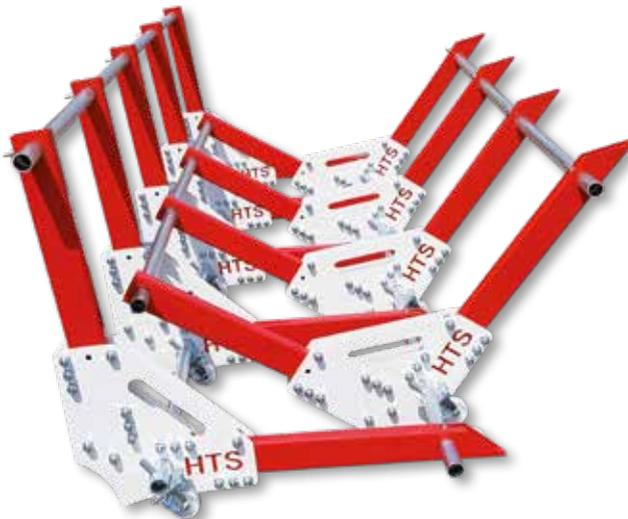
Die Effizienz der HTS wird durch die Montage in Doppelreihe deutlich erhöht. Ein angreifender LKW kippt die erste Reihe, die Unterschenkel der Sperre stoßen in den Unterboden und verhaken sich dort. Wenn die hintere Reihe überfahren wird, verwickelt sich das Material noch stärker unter dem Fahrzeug. Die Wirkweise wurde durch Tests bestätigt.
